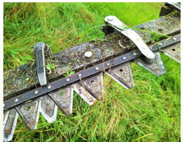
Doppelmesser-Mähbalken sind besonders insekten-schonende Mähwerke.
