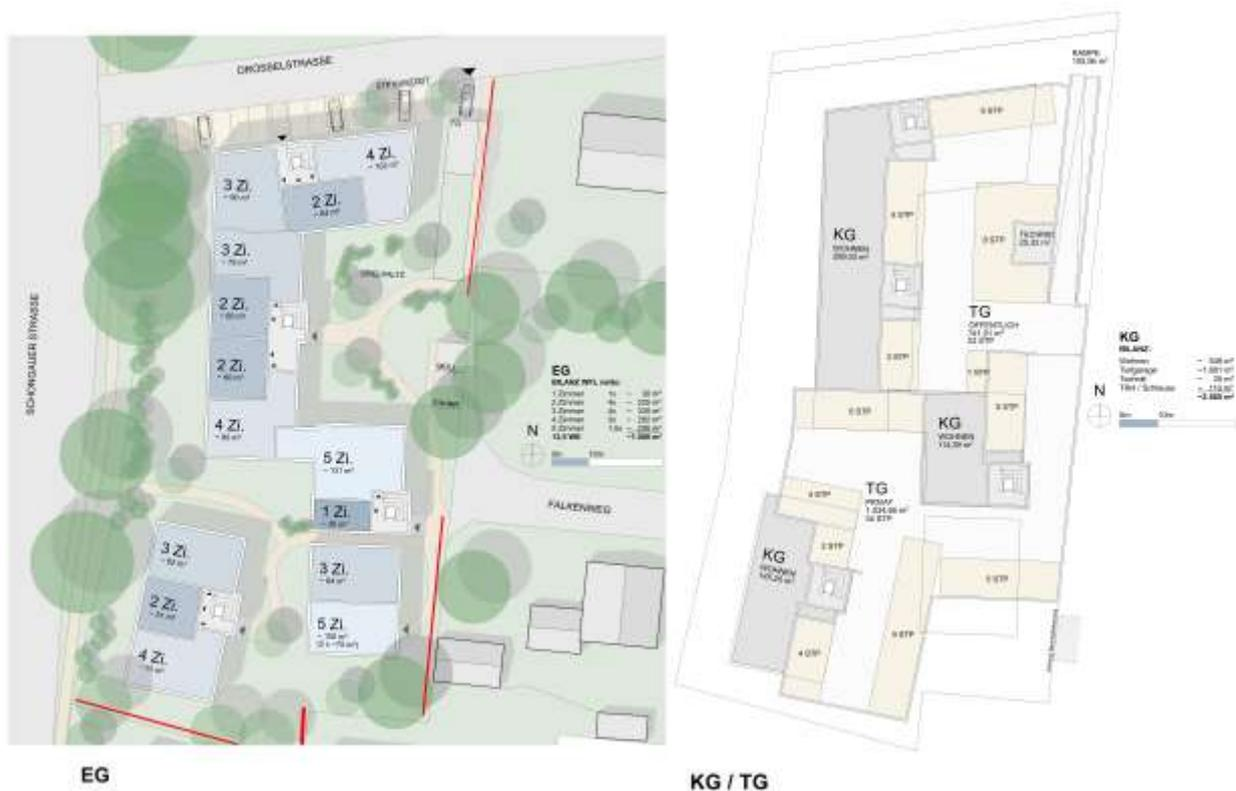
Abbildung 2 (links): Entwurf der geplanten Wohnanlage (rot skizziert = möglicher Verlauf von Verbaumaßnahmen)
