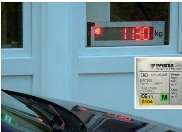
Für die Waagen der EVA GmbH gilt ab 2016 eine grundsätzliche Mindestlast von 100 kg. Damit Rechtssicherheit für beide Seiten – Anlieferer und Betreiber – gegeben ist, werden die Waagen regelmäßig vom Eichamt überprüft und nachjustiert.
