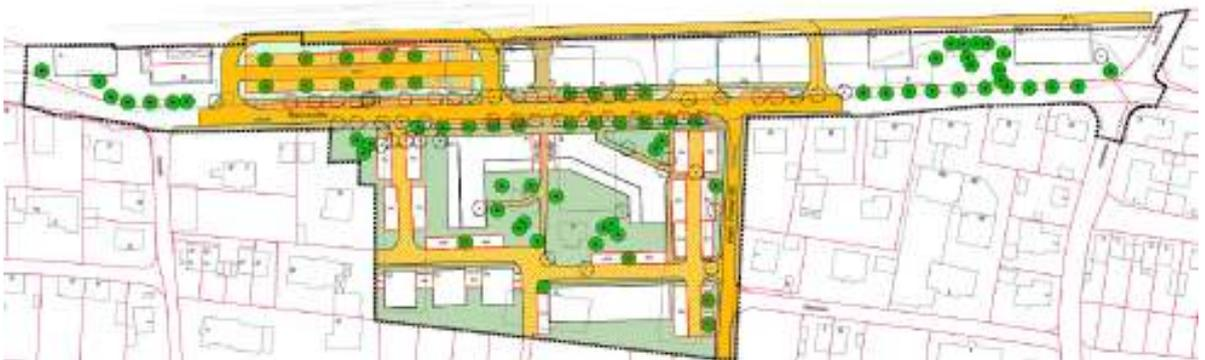
Nördlich der Bahnhofstraße zum südlichen Ausgang des Bahnhofes entsteht eine P+R – Anlage mit 66 Stellplätzen und einer Busspur zum Andienen des Bahnsteiges. Für Fahrräder wird eine Bike & Ride Anlage mit integriert.
